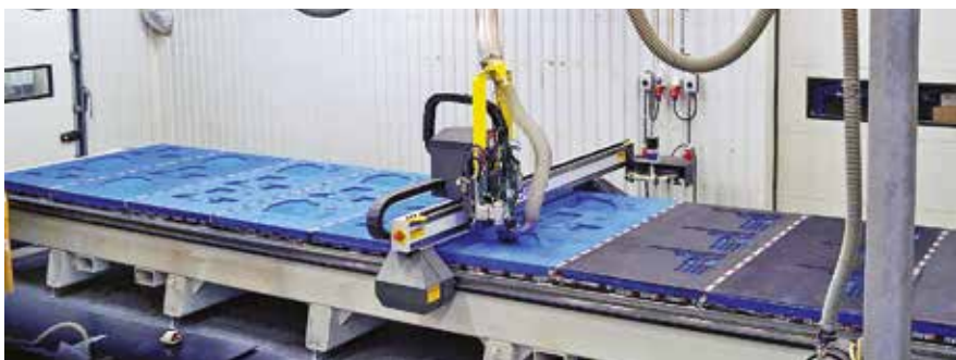
Datastyrte maskiner freser ut skumplast tilpasset innholdet som skal oppbevares.
