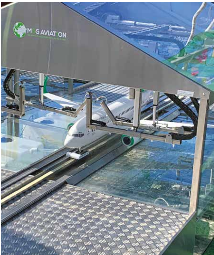
Mye spennende å se under Arendals-uka. MSG Aviation har laget en genial vaskemaskin for flere typer fly. Den kan også ta seg «De-icing». Det spennende er at «de-icing» væsken resirkuleres og kan brukes på nytt. Avinor vurderer systemet, og Luftforsvaret burde vel også vurdere dette til sine P-8 Poseidon fly på Evenes i fremtiden? Utvidet artikkel om dette i neste utgave.
