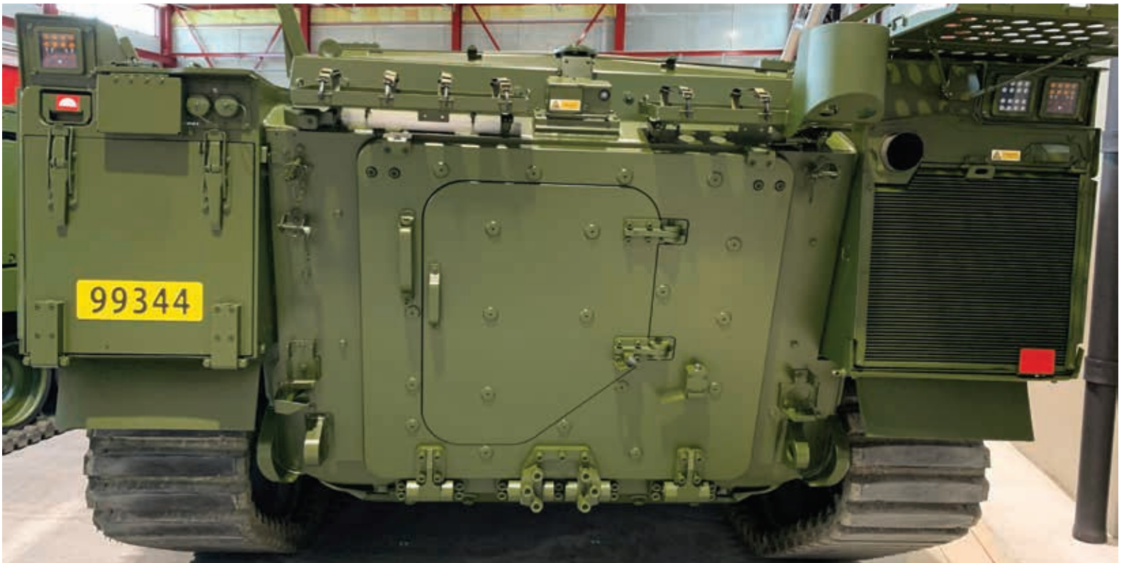
Kamp støtte vognene har fått rampe for lettere inn og utlasting.
