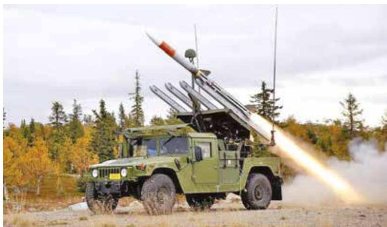
Hærens luftvern på mobilt lettere kjøretøy (Humvee), er basert på NASAMS teknologi.
