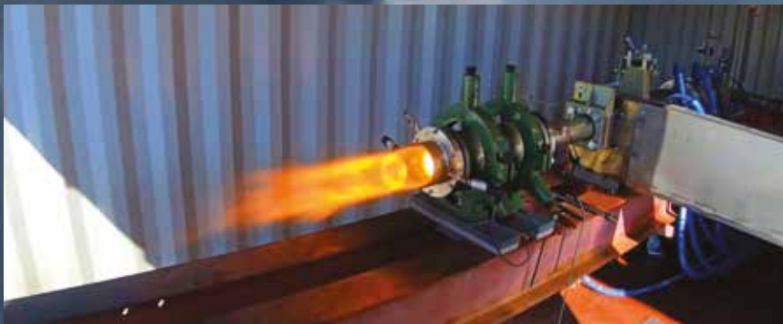
Både hos FFI på Kjeller, hos Nammo på Raufoss og i China Lake i USA er det satt opp testanlegg hvor forskerne «flyr» ramjet-motorene i ulike høyder og hastigheter. Foto: Nammo
