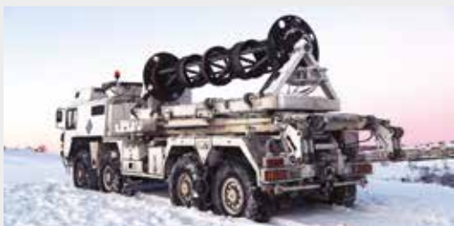
Forsvarets kjøretøy med markforsterkningsmatter i skredområdet.
