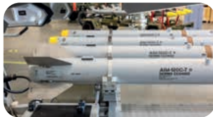
AIM 120 C brukes både av F35 og våre NASAMS systemer. Foto Forsvaret.
