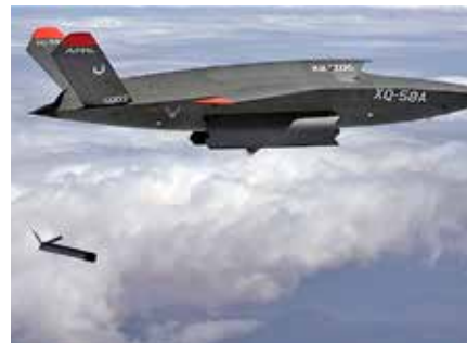
Lojal wingman Valkyrie Altius 600 som også bærer våpenlast Foto US Air Force.
