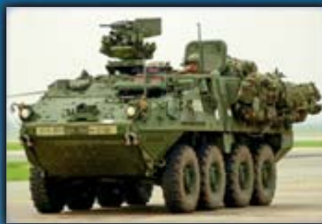
Protector Remote Weapons Systems montert på "Stryker" kampkjøretøy.
