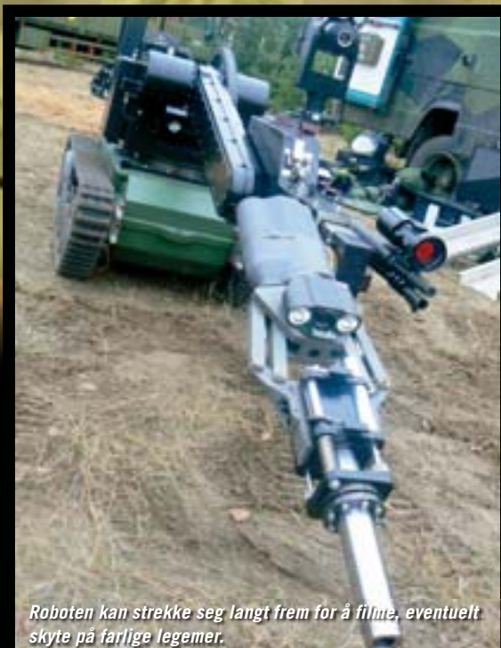
Roboten er utstyrt med gripearm, avanserte kamaraer og flere typer avfyringssystemer for å ødelegge farlig gods. Den har blant annet en høyhastighets vannkanonladning.
