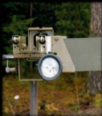
FalconEye monteret på SoftMount for 12,7mm maskingevær. SoftMount for 12,7mm maskingevær er Vinhøgs produkt. Den ble opprinnelig utviklet av Merlin Design men er senere videreutviklet av Tronerud Engineering.
