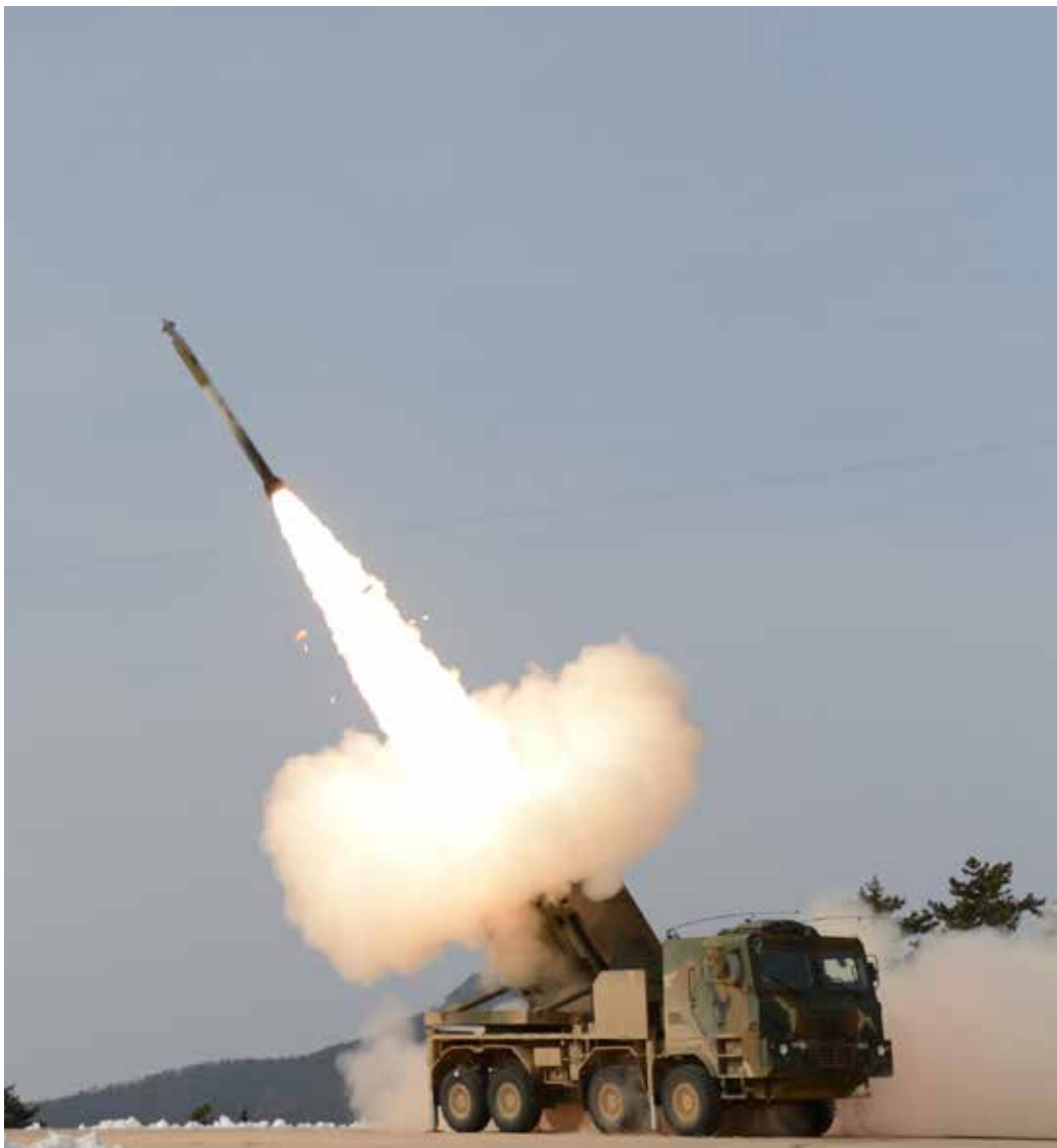
CHUNMOO avfyring av den høy-eksplosive 239 mm styrte artilleriraketten. Foto: Hanwha
