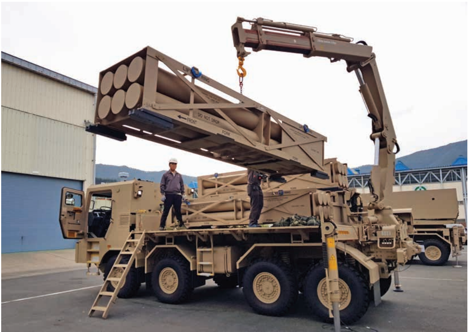
Ammunisjons kjøretøyet som med fire magasiner med raketter sørger for etterforsyning til to CHUNMOO. Foto: Hanwha
