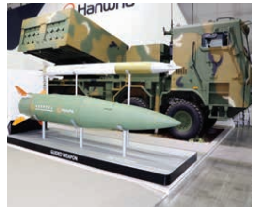
CHUNMOO MLRS vist under DX Korea 2018 på Hanwha Corporations stand. Den 239 mm styrte raketten (øverst), Det større missilet (nedenfor) er betegnet KTSSM: Koreansk taktisk bakke-til-bakke missil, et høy eksplosiv styrt ballistisk missil. Hittil er missilet avfyrt fra en fast våpendel. Foto: Walter Christian Håland
