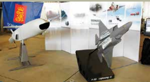
Modell i riktig størrelse av Kongsbergs Joint Strike Missile (JSM) og en skala modell av F-35 med åpne luker til våpen last rommet. JSM er den luftbårne varianten av NSM som er designet for F-35 etter kravene til det norske luftfor svaret og medbringes i de innvendige våpenrommene, men ekstra JSM kan i tillegg bæres i utvendige oppheng. Foto: Torbjørn Kjosvold/Forsvaret
