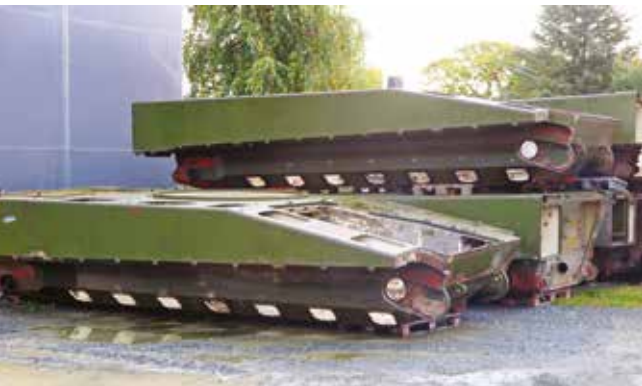
Stabler med chassiser klare for bearbeiding hos Ritek.
