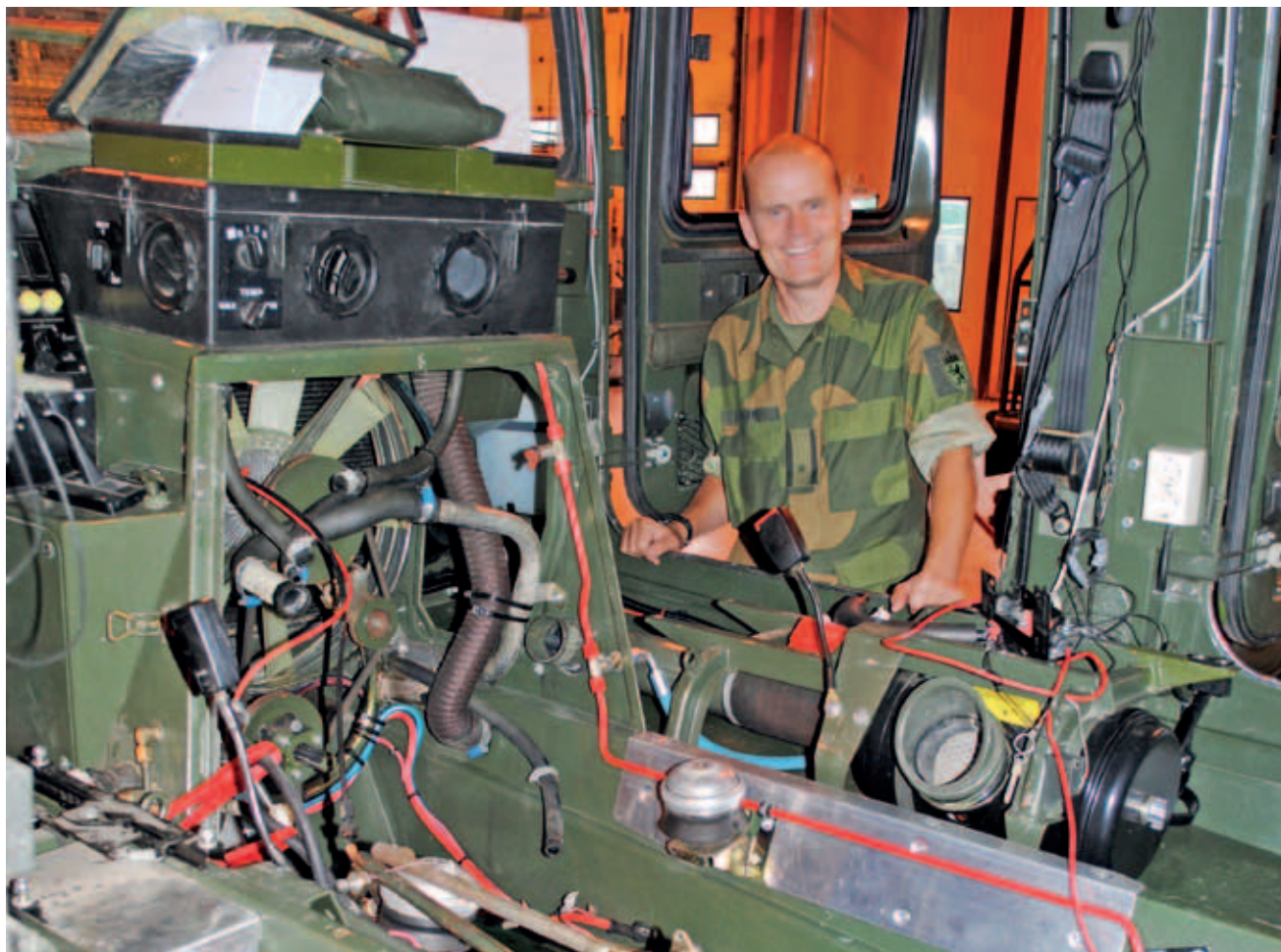
Slik ser en BV 206 ut etter at motoren er fjernet for overhaling.
