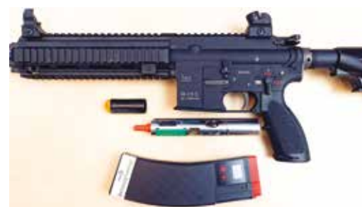
HK 416 med Green Ammos E-blanks system. Foto Forsvarets forum.
