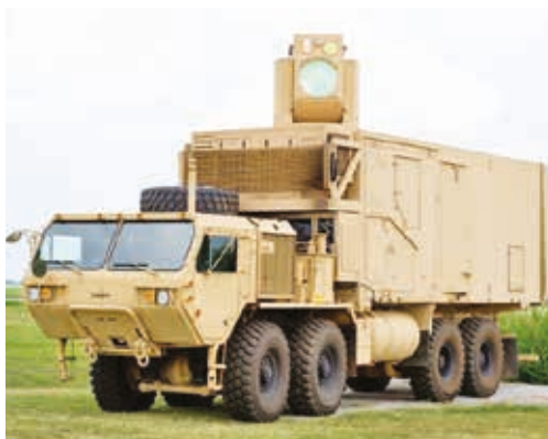
Mobilt DEW laseervåpen montert på feltvogn.
