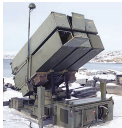
Vårt NASAMS luftvernssystem bruker per i dag også AMRAAM-missiler.
