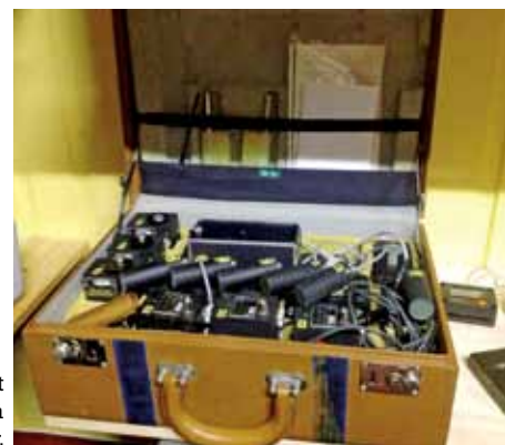
Spesialradiomottager brukt i sikkerhetstjenesten for å finne skjult avlyttingsutstyr.
