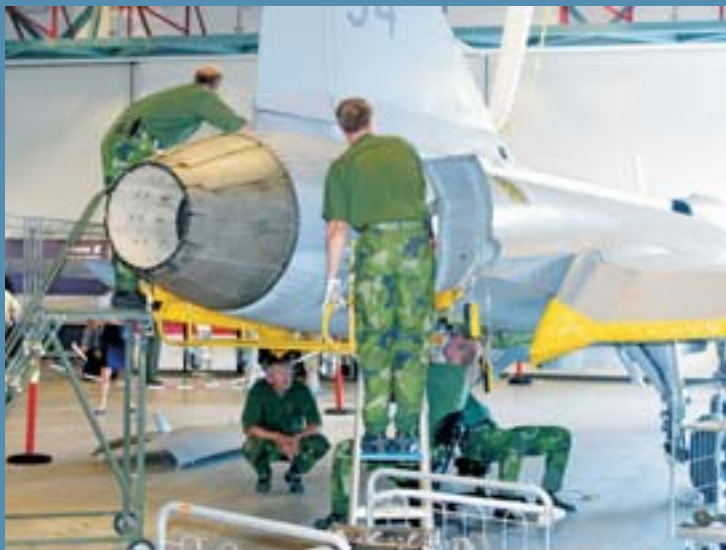
Svenskene beviste at et mannskap på fire kan skifte Gripens motor og gjøre den klar til take off på under tre timer.
