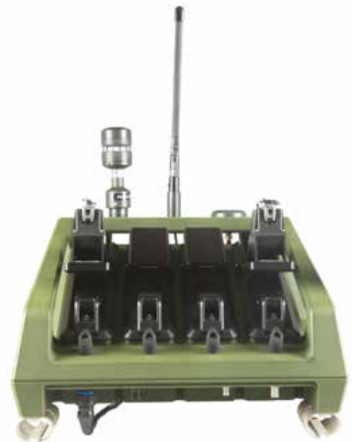
I «hangaren» som kan plasseres utenpå kampkjøretøyet, er det plass til fire Black Hornet 3-droner. Foto: FLIR Systems
