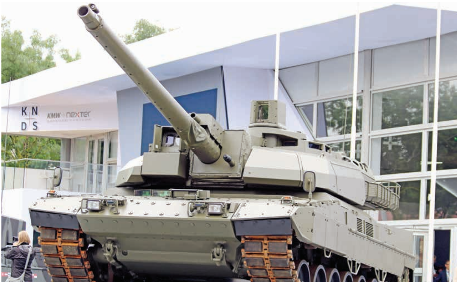
En stridsvogn med Leclerc kanontårnsystem montert på et Leopard 2 chassis (ikke neste generasjons Main Ground Combat System). En demonstrasjon for KNDS – KMW+Nexter samarbeid. Foto: Aud Håland
