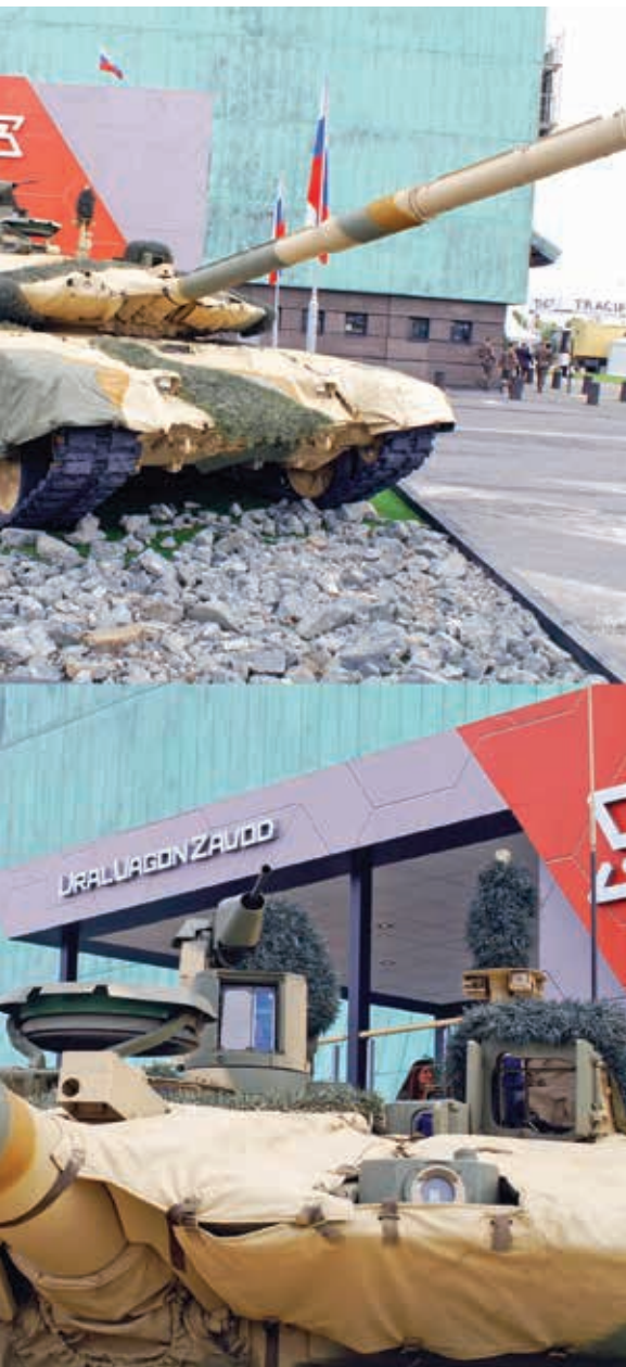
T-90S MODERNIZED, her før og etterat den ble dekket av IR-signatur dempende overtrekk. Foto: Aud Håland.
