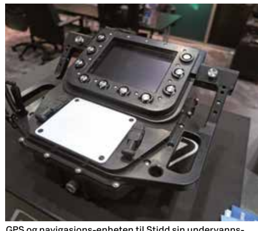
GPS og navigasjons-enheten til Stidd sin undervanns-farkost, som også kan tas ut av fartøyet, og brukes av dykkerne under svømming frem mot målet.
