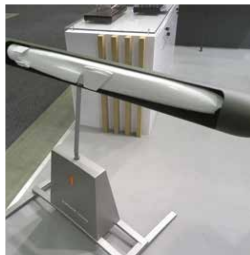
Her er Kongsbergs modell av en spesialbygget NSM innbygd slik at den avfyres fra ubåt i undervannsposisjon.
