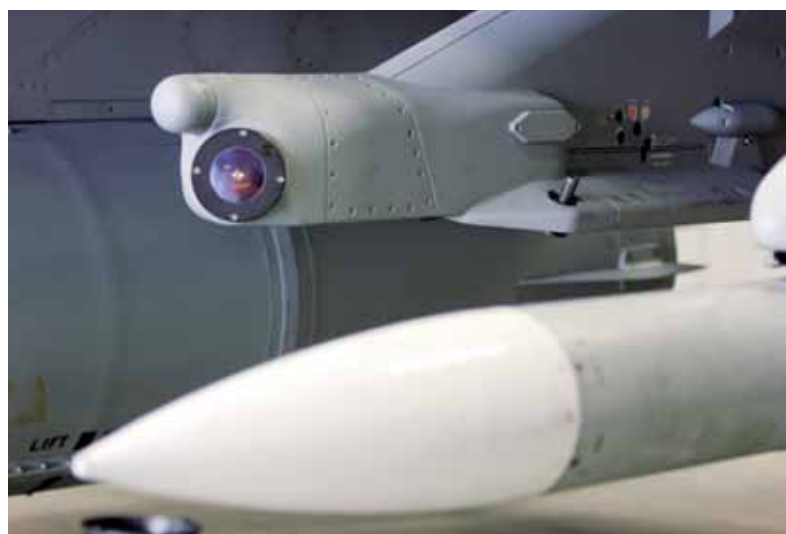
Innenfor Amraam missilet ser vi missil varslings pod'en med sensorer (1 sensor foran og to bak)
