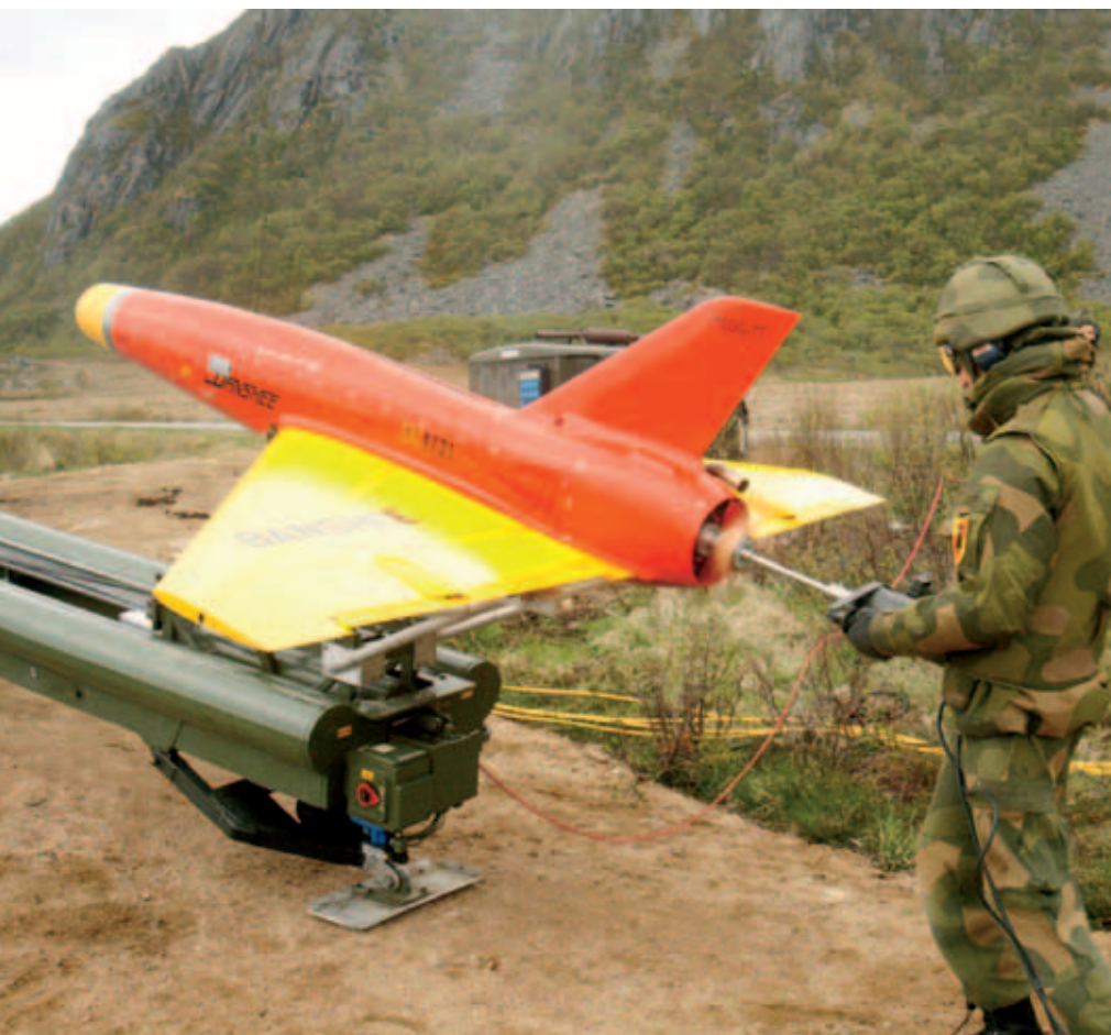
Motoren på dronen startes.
