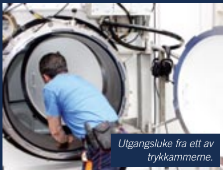
Redningsubåten kobles rett inn på luka til trykkammer som en montert på KV Harstad.
