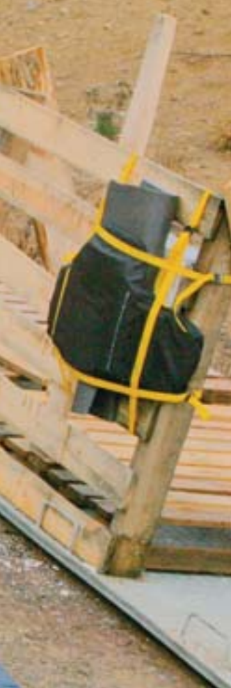
- Fra en skytetest på TAC TOP, hvor finsk politi skjøt med kaliber tilsvarende AK-47 på tre meters hold. Vesten stoppet alle skuddene.
