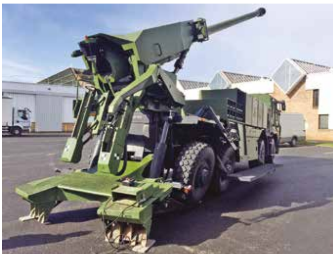
Caesar 8x8 med halv-automatisk ladesystem.
