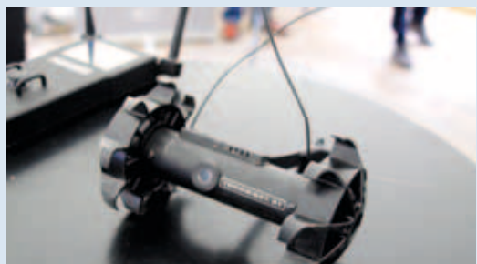
Tohjuls fjernstyrt spionrobot med høy fremkommelighet.
