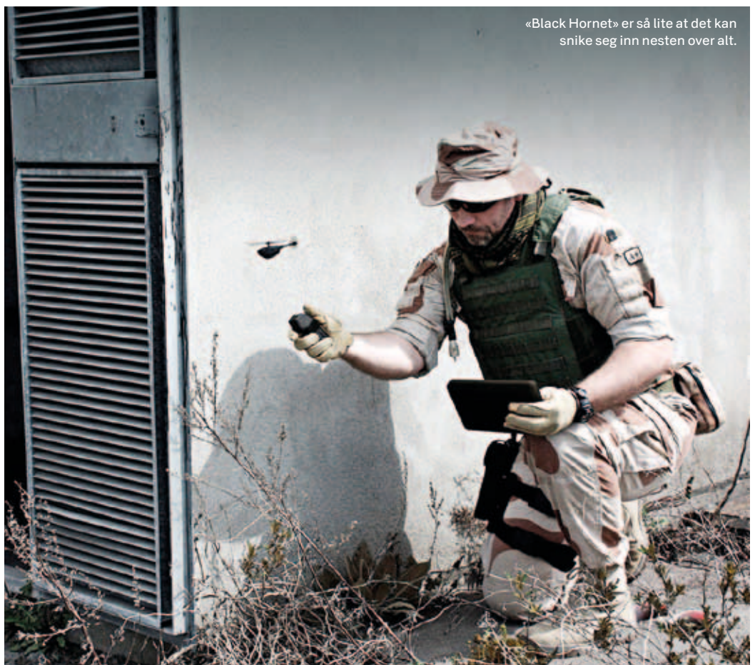
Prox Dynamics 16 grams Nano-UAV PD-100 «Black Hornet».
