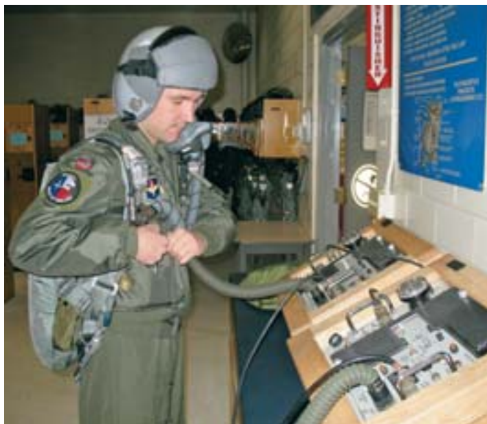
At surstoffmasken fungerer slik den skal sjekkes før hver tur.
