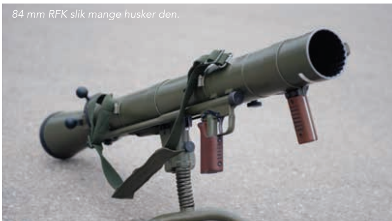
Bærehåndtak, mye lettere ved bruk av karbonfiber og moderne siktemidler.
