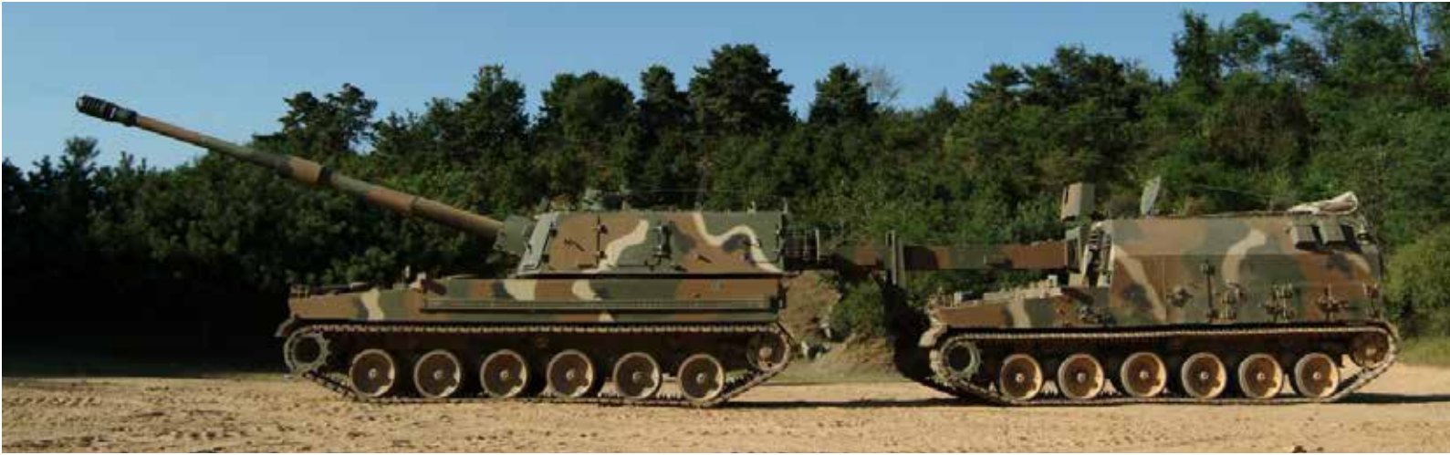
K10 ARV oppfyller kravene til den vesentlig økte mengden ammunisjon som brukes i moderne krigføring slik at K9 Thunder kan oppfylle de taktiske kravene til hurtig skyting med stort effektivolum og Shoot & Scoot. K10 har en fullt ut automatisert ammunisjons etterforsynings evne til å maksimere effektiviteten til artilleribatterier. Vogn delen til K10 er lik K9 og det gir samme taktisk mobilitet og effektivitet i logistikkstøtten. Foto Hanwha Techwin
