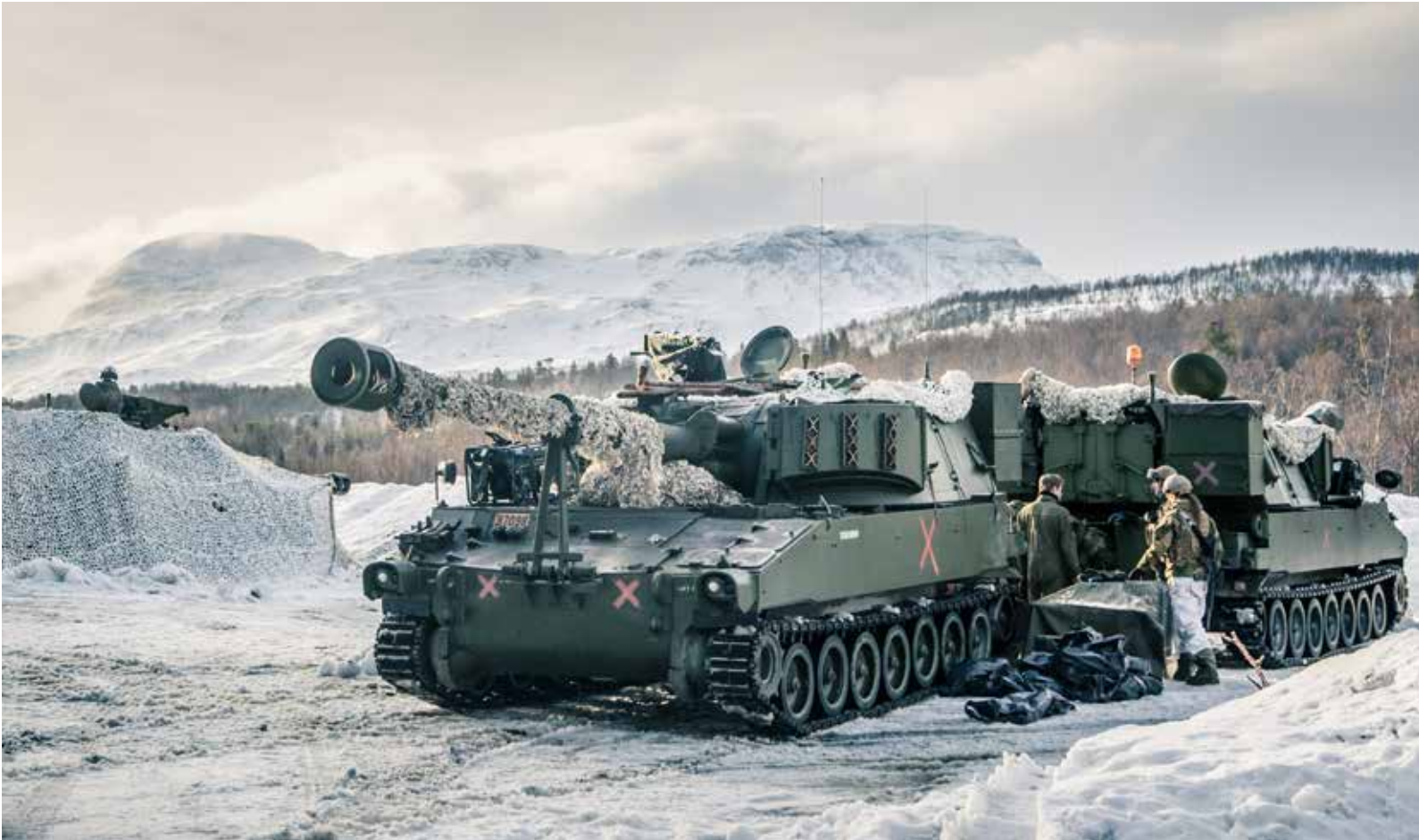
De gamle norske hærens M109A3GN, kan ikke ta seg fram over kupert terrenget i dyp snø og utføre umiddelbart et ildoppdrag. Ildstillinger må i så fall klargjøres med snøryddings maskiner. Foto: Ole-Sverre Haugli/Forsvaret
