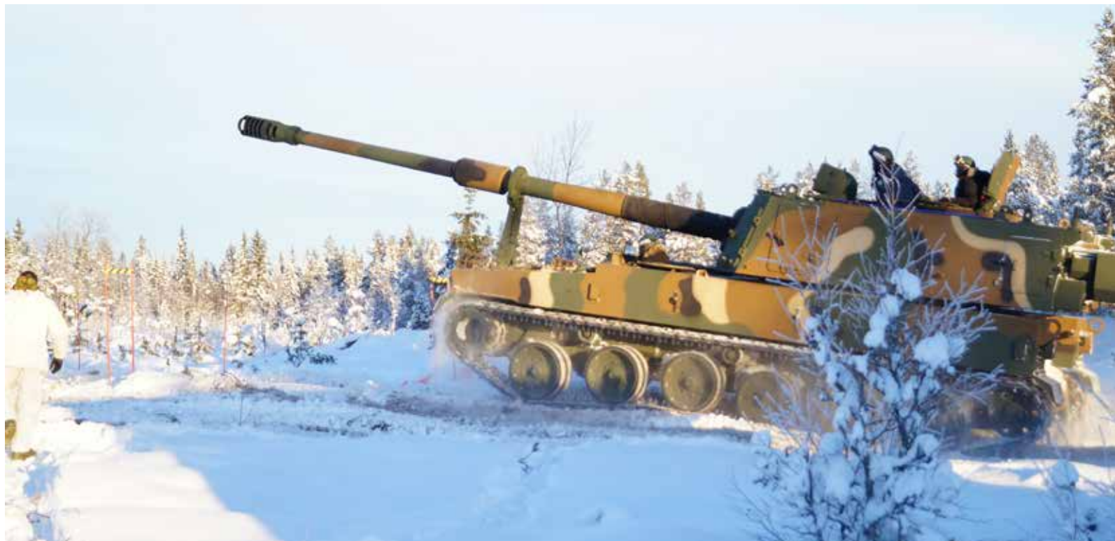
Høyere mobilitet - utstyrt med en 1000 hk dieselmotor med motorkraft-til-vekt-forhold på 21,6 hk /tonn og med et hydro-pneumatiske fjæringssystem, gjennomføres «skyt og stikk av» ildoppdrag med K9 Thunder i varierende omgivelser og terreng. Foto: Walter Christian Håland
