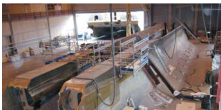
Så snart er katamaranskrogene til et fartøy er ferdige, blir de snudd og sammenføyd.
